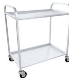
Тележка официантская ТОН-2 нерж., 800(835)x500(535)x925 мм Выпускаются в двух сериях Эконом и Стандарт. В серии Стандарт каркас из трубы 20x20 и полки выполнены из нержавеющей стали. Могут изготавливаться с двумя или 3 полками высотой борта 30 мм. Тележки оснащены 4 поворотными колесами, одно из которых имеет стопор. Поставляется в собранном виде. Упаковка стрейч-пленка.
