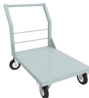
Тележка грузовая транспортировочная 4-х колесная ТТ-300, 1100x630x880 мм, до 300кг Грузоподъемность 300 кг. Высота платформы (от пола): 235мм. Тележки предназначены для перевозки крупногабаритных тяжелых грузов. В зависимости от грузоподъемности оснащаются двумя или четырьмя колесами. Четырехколесные модели оснащаются стопором на одном колесе. Изготавливаются из стали окрашенной порошковой краской серого цвета. Поставляются в собранном виде. Упаковка стрейч-пленка.
