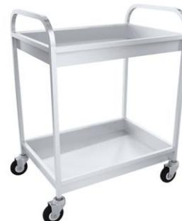
Тележка официантская для сбора посуды ТОСПб-2 нерж., 735x535x925 мм. В серии Стандарт каркас из трубы 20x20 и полки выполнены из нержавеющей стали. Изготавливаются с двумя полками высотой борта 80 мм. Тележки оснащены 4 поворотными колесами, одно из которых имеет стопор. Поставляется в собранном виде. Упаковка стрейч-пленка.
