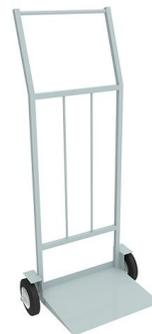
Тележка грузовая транспортировочная 2-х колесная ТТ-200, 580x440x1210 мм, до 200 кг. Грузоподъемность 200 кг. Высота поверхности платформы от пола (не более): 85мм. Тележки предназначены для перевозки крупногабаритных тяжелых грузов. В зависимости от грузоподъемности оснащаются двумя или четырьмя колесами. Четырехколесные модели оснащаются стопором на одном колесе. Изготавливаются из стали окрашенной порошковой краской серого цвета. Поставляются в собранном виде. Упаковка стрейч-пленка.
