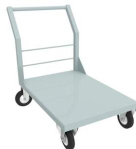
Тележка грузовая транспортировочная 4-х колесная ТТ-500, 1530x630x880 мм Грузоподъемность 500 кг. Высота платформы (от пола): 235мм. Тележки предназначены для перевозки крупногабаритных тяжелых грузов. В зависимости от грузоподъемности оснащаются двумя или четырьмя колесами. Четырехколесные модели оснащаются стопором на одном колесе. Изготавливаются из стали окрашенной порошковой краской серого цвета. Поставляются в собранном виде. Упаковка стрейч-пленка.
