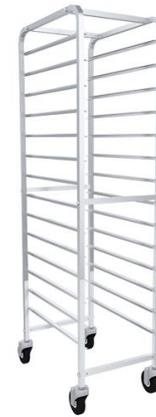
Тележка-шпилька для gastronormов ТШ-11 нержав. (373x565x1560мм, 14 уровней для GN 1/1) Выполнена из нержавеющей стали, оснащена 4 колесами одно из которых имеет стопор. Вмещает 14 gastronormов GN 1/1 или 28 gastronormов размером GN 1/2. Поставляется в разобранном виде. Упаковка гофрокартон. Поддоны и gastronormы в комплект не входят.
