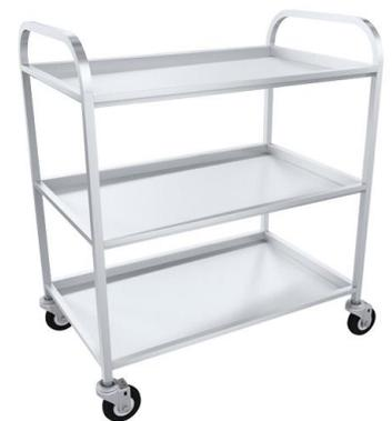
Тележка официантская ТОН-3 нерж., 800(835)x500(535)x925 мм Выпускаются в двух сериях Эконом и Стандарт. В серии Стандарт каркас из трубы 20x20 и полки выполнены из нержавеющей стали. Могут изготавливаться с двумя или 3 полками высотой борта 30 мм. Тележки оснащены 4 поворотными колесами, одно из которых имеет стопор. Поставляется в собранном виде. Упаковка стрейч-пленка.
