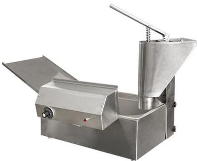
Аппарат для приготовления и жарки пончиков АПЖП-2 настольный (930x570x670)мм, на 7л масла, 3кВт,220В 2 ТЭН-а. Общий объем ванны: 20 л. Заправочный объем масла: 7 л. Глубина ванны 150мм. Температура масла в рабочем состоянии  $200\pm 10^{\circ}\text{C}$ . Время разогрева масла до рабочего состояния 20 мин. Время жарки изделия 3 мин.
