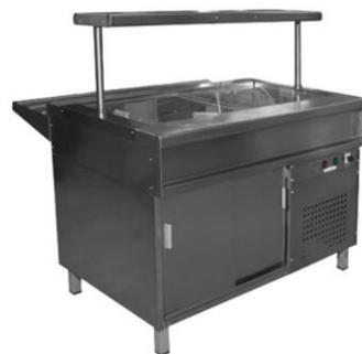
Стол охлаждаемый Ли́ра/СОЭП-О (1210x770(1100)x840(1160) мм, 0,37кВт, 220В) Стол охлаждаемый предназначен для кратковременного хранения и раздачи потребителю блюд, требующих хранения в охлажденном состоянии. Занимаемая площадь не более 0,9 м<sup>2</sup>. Температура полезного объема -1...+5 °С. 1 полка (при поставке в линии). Направляющие для подносов (при поставке в линии). Высота стола охлаждаемого регулируется опорами.
