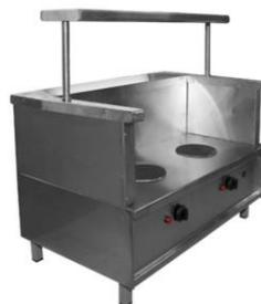
Мармит 1-х блюд 2 конфорки "Ли́ра" (МЭП-1Б-2) (1210x770(1100)x845(1250) мм, 2конф., 4кВт, 380В) Мармит электрический промышленный для первых блюд МЭП-1Б предназначен для кратковременного сохранения в горячем состоянии первых блюд в наплитных котлах, а также для раздачи их потребителю. Каркас изготовлен из профильной окрашенной трубы и облицован нержавеющей пищевой сталью. Количество конфорок 2 шт. Время разогрева конфорок до температуры 280°C за 40 мин.
