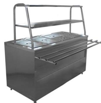
Мармит 2-х блюд 7 гастр. Лира-Профи МЭП-2Б/ЛП-1500 (1500x705(1030)x1462(1482)мм, нерж.сталь, 1,6 кВт, 220 В) Мармит 2-х блюд МЭП-2Б/ЛП Лира-Профи предназначен для кратковременного сохранения в горячем состоянии вторых блюд, соусов и гарниров в гастроёмкостях и раздачи их потребителю.
