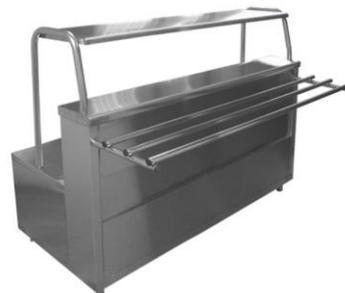
Мармит 1-х блюд 3 конф. Лира-Профи (МЭП-1Б/ЛП-1500) (1500x705(1030)x1220(1240) мм, 3 кВт, 220/380 В) Мармит электрический для первых блюд предназначен для кратковременного сохранения в горячем состоянии первых блюд в наплитных котлах и раздачи их потребителю.
